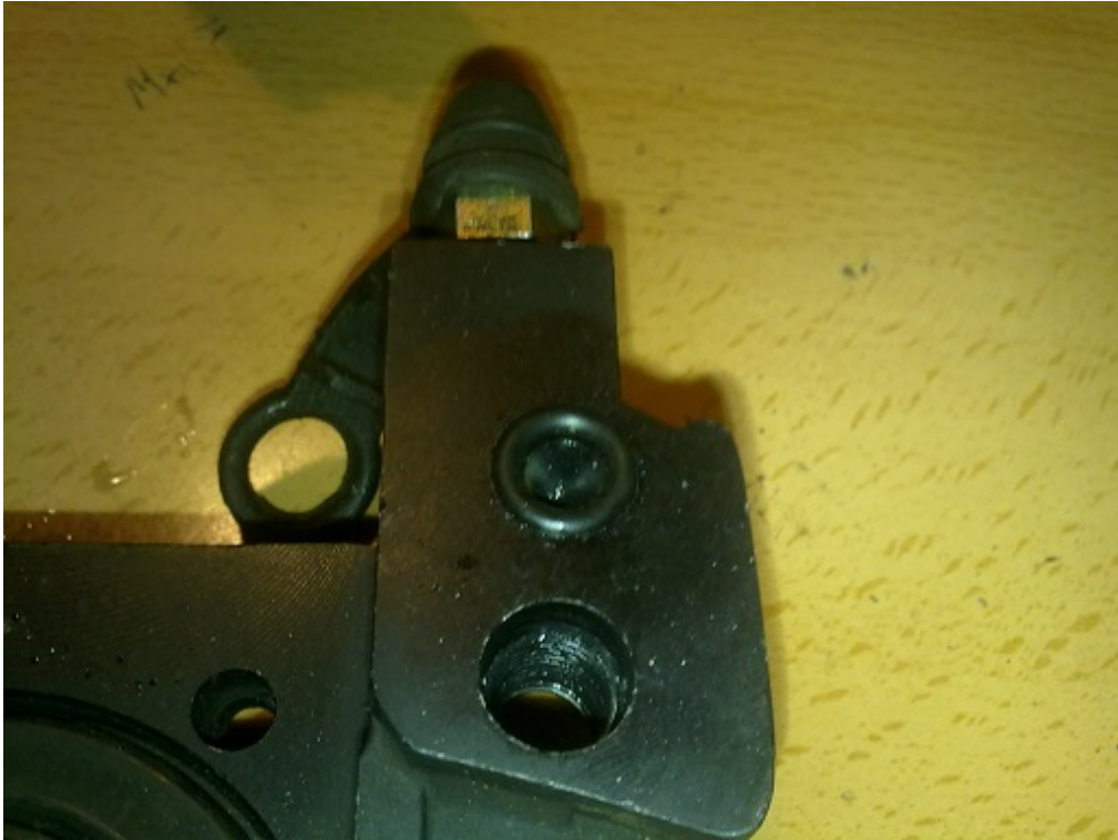
Detalle de la junta tórica que no debes perder y por donde podemos meter presión para sacar el piston.
