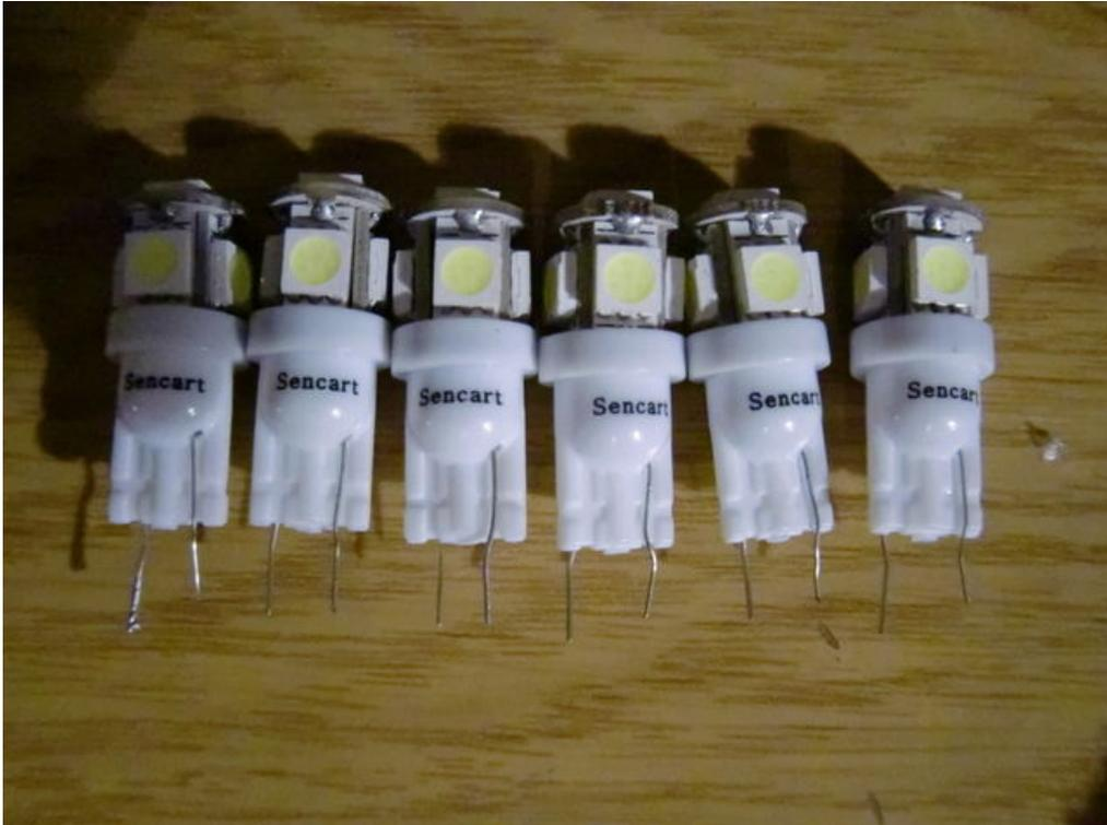
Tendréis que abrir las patas para comprobar la polaridad de los Led se puede hacer con una pila de 9 V
