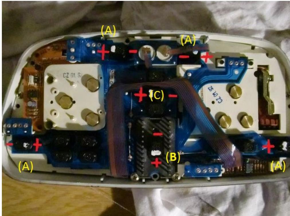
Aqui teneis sus posiciones. Se podrían cambiar todas las lamparas por led menos la de indicación de carga del alternador.
