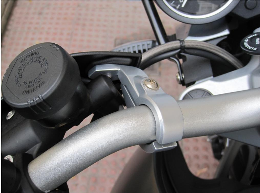
Detalle de la abrazadera original izquierda, en la que no ha sido necesario añadir ninguna pieza-puente.
