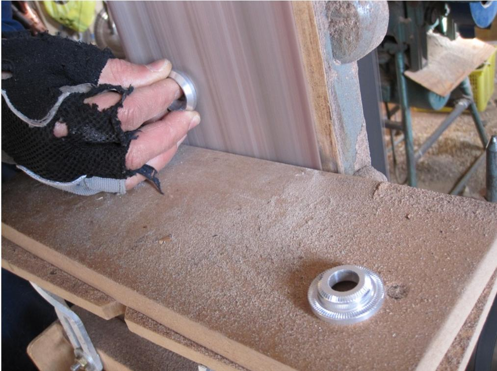
3. En una lijadora vertical, eliminamos la parte cónica interna de los embellecedores de aluminio originales. La superficie plana resultante permitirá que ajusten en el orificio del cubremanos sin sobresalir.
