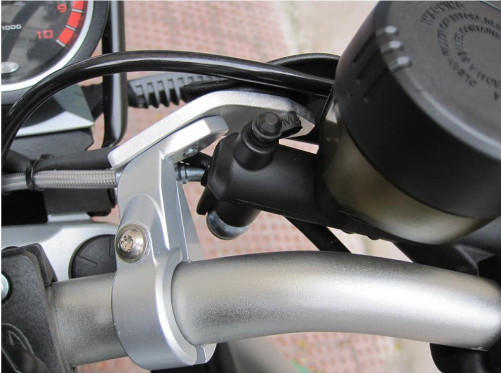
18. Detalle de la pieza-puente entre la abrazadera original derecha y el cubremanos.
