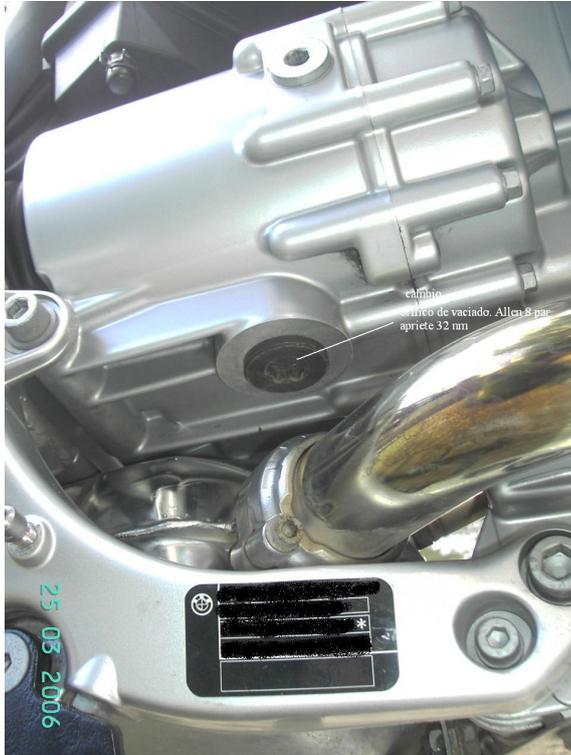
aquí señalo los orificios de vaciado y llenado del cambio y en la foto siguiente como me apañaba yo para el vaciado sin manchar.....
