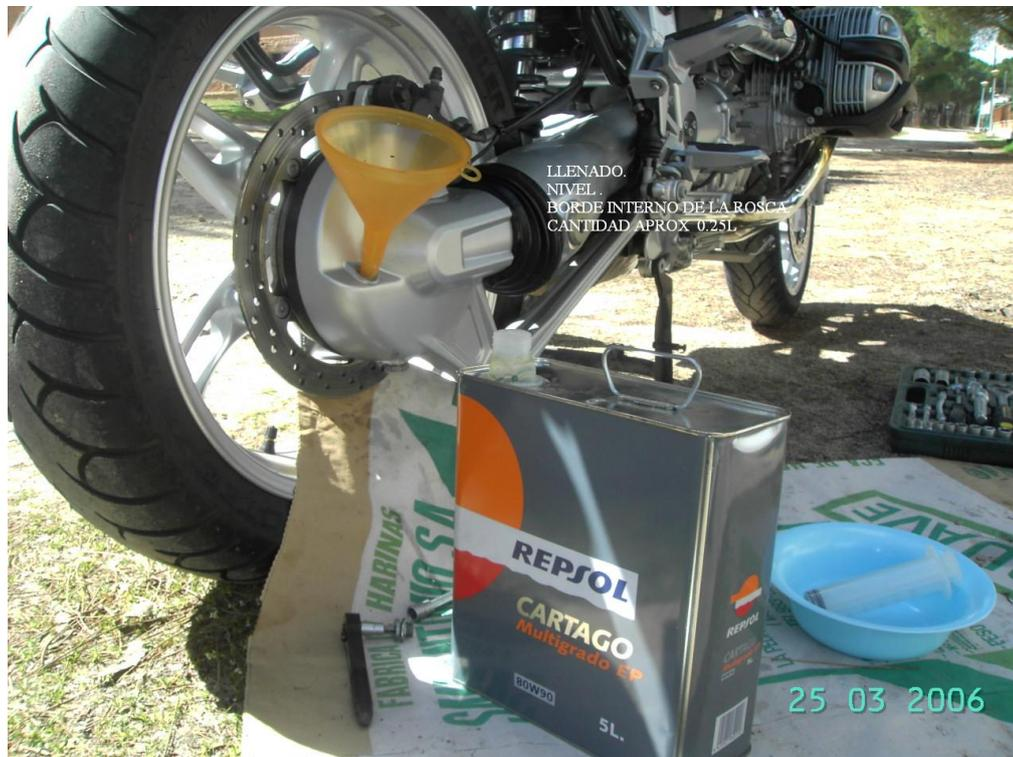
lo mismo en la trasmisión..... hasta el limite inferior del orificio de llenado..
