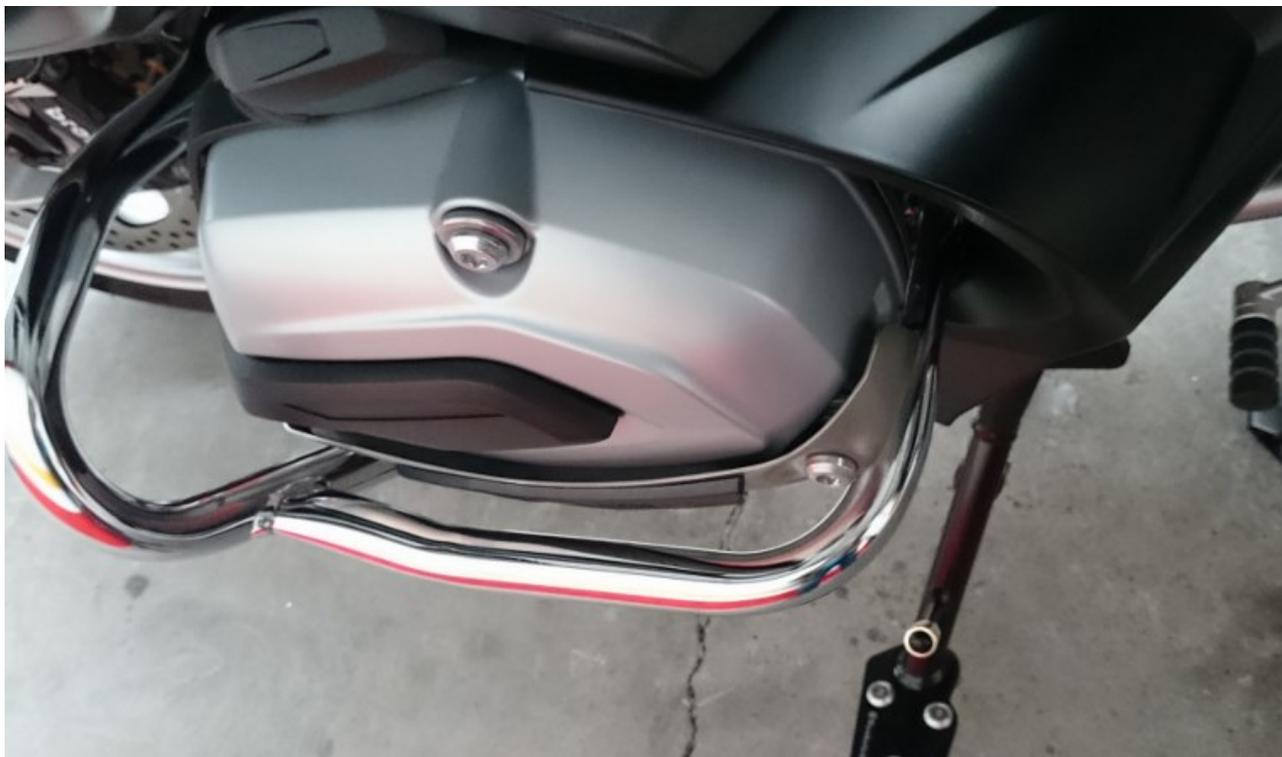
12.- Aquí se ve como queda la barra protectora y el protector del cilindro de BMW juntos. Quedando libre por todos los lados gracias al limado de la cabeza del tornillo largo que efectuamos antes.
