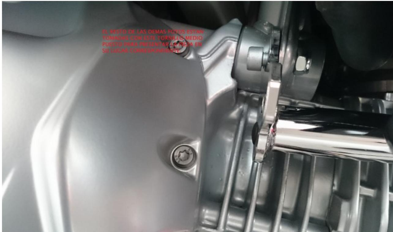
9.- En esta foto indico la parte de sujeción que se debe de empezar a poner primero, para que sea más fácil su colocación (Esta es la pieza del lado izquierdo) La pieza del lado derecho se tiene que empezar por la parte de abajo, quitando primero el tornillo largo que tiene la moto y cambiarlo por el que viene en el kit de tornillos.
