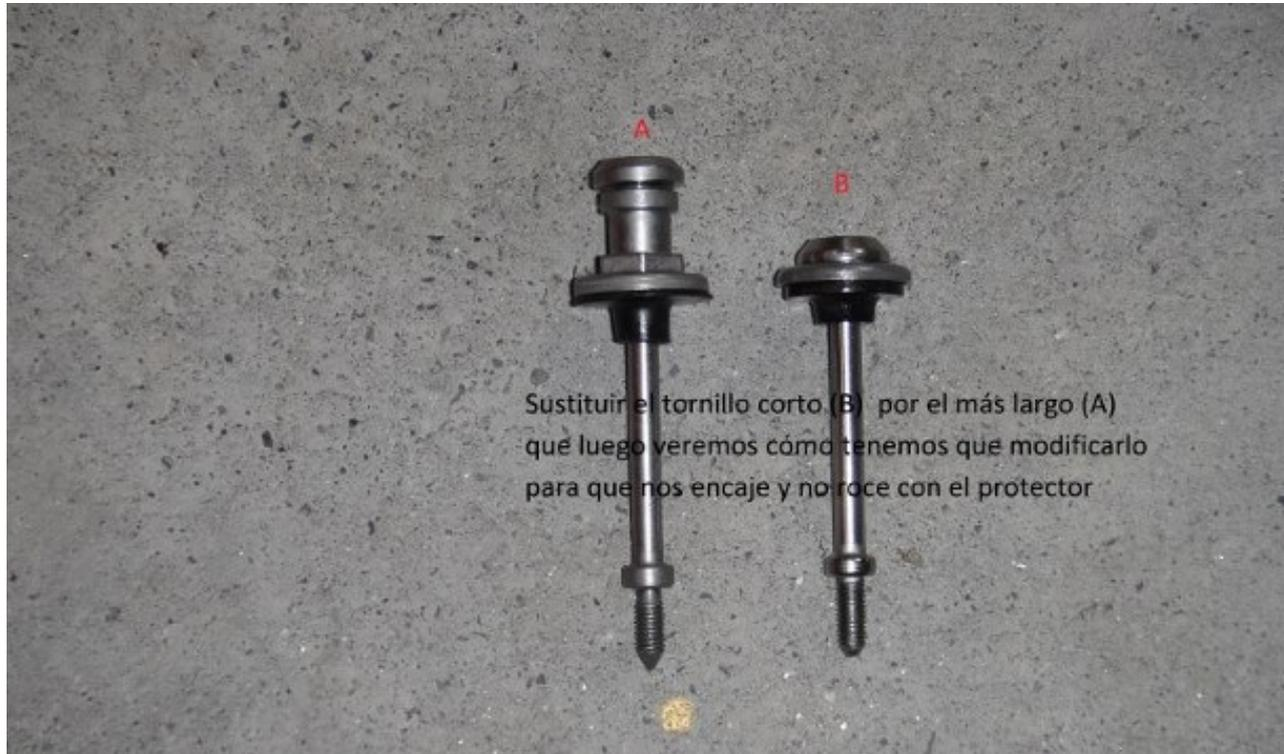
7.- Si la moto viene con el extra de las protecciones de BMW no hace falta cambiar los dos tornillos largos de ambos cilindros. Pero si la moto viene sin ellos y quieres poner las dos cosas a la vez, como es en mi caso. Solamente tienes que cambiar uno por otro y limar la parte superior del tornillo más largo por la mitad, como indico en la siguiente foto.
