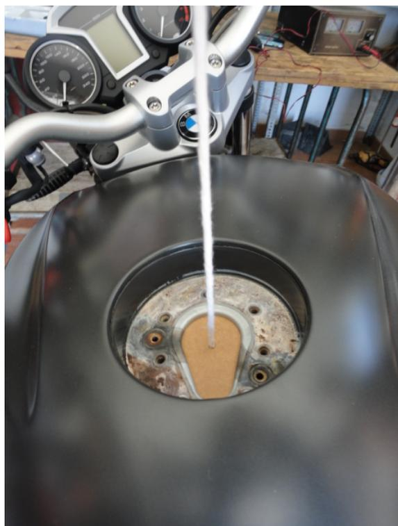
Colocamos el "tapon experimental", para evitar que entre cualquier suciedad durante su reparacion.
