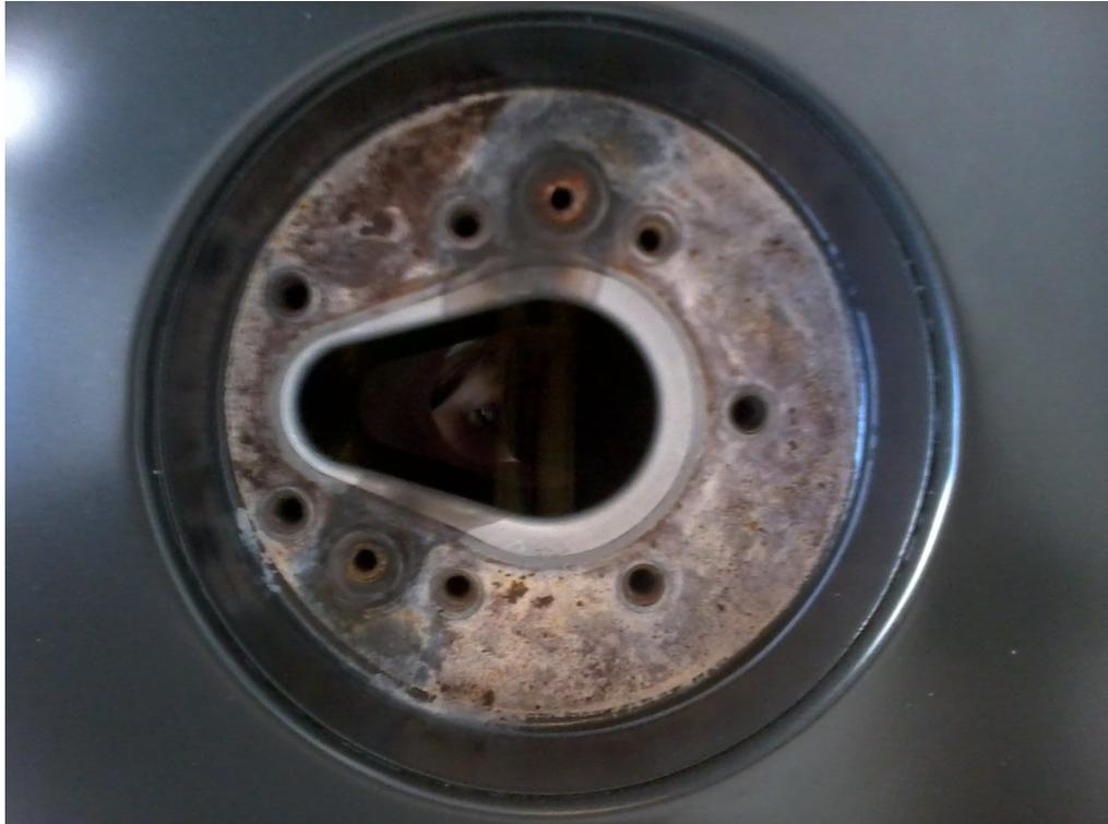
Manual para la reparación de la acumulación de oxido en el deposito de la R1200R.
