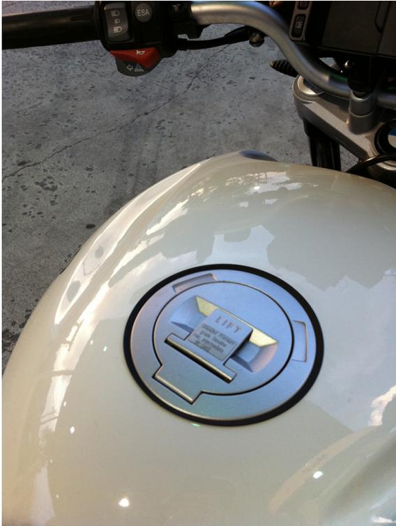
Otra imagen de como queda el deposito de una R1200R con la junta montada y lista.
