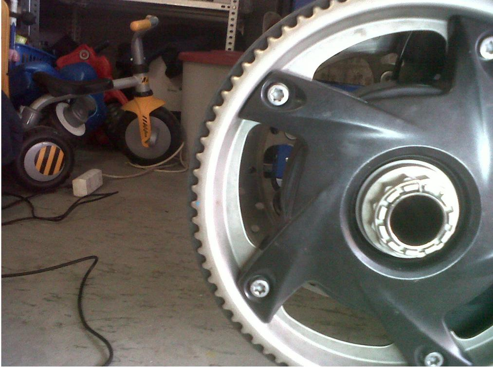
Tensamos al correa con el puntito azul hacia detrás (yo lo hice a ojo... ni muy tensa ni muy floja como una cadena de las de siempre) y colocamos la cubierta de plástico
