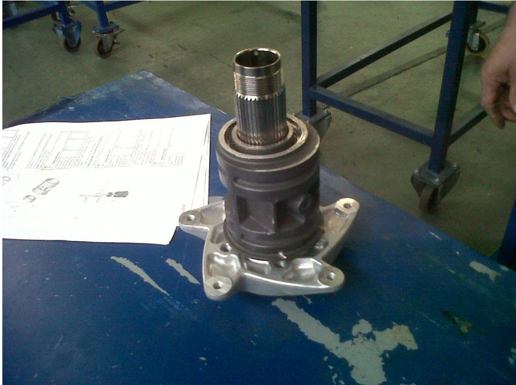
Limpiamos todo bien para empezar el montaje. Metemos el eje en el congelador (debe estar a  $-10^{\circ}\text{C}$  para el montaje) y metemos en el horno la excéntrica (debemos llevarla la pieza a  $80^{\circ}\text{C}$ ) Una vez han alcanzado su temperatura, extraemos el rodamiento de rodillos viejo que se ha quedado dentro de la excéntrica y metemos el nuevo rodamiento de rodillos, lo sujetamos con el circlip y lo colocamos todo dentro del eje nuevo.
