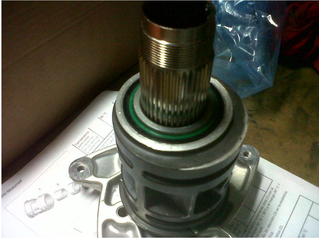
Tras insertar los dos pasadores para sujetar el rodamiento izquierdo, volver a a colocar el sello nuevo y atornillar el disco de freno con los nuevos tornillos tenemos el eje listo para instalarse en cuanto le demos un poco de grasa.
