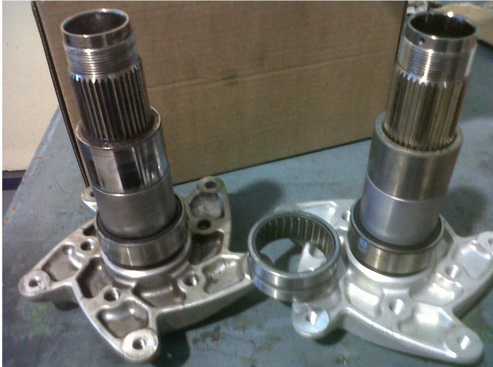
Ahora debemos sacarlos con un botador fino los dos espárragos de sujeción del rodamiento interno de la excéntrica. Con un extractor de tres patas de tamaño mediano, sacamos la excéntrica del eje. En nuestro caso el problema provenía del rodamiento cónico del extremo izquierdo del eje que estaba dañado y con mucha holgura y del rodamiento derecho de rodillos que estaba casi gripado. Una vez fuera la excéntrica sacamos el retén y un circlip de sujeción del rodamiento de rodillos.
