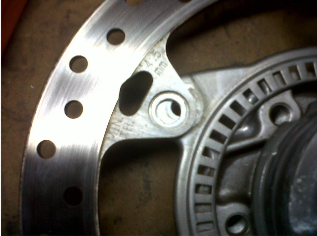
Nos llevamos el eje banco de trabajo y le desmontamos el disco de freno y la plaquita de la rueda fónica del ABS. Ojo al detalle grabado en el disco (grosor mínimo 4,5 mm)
