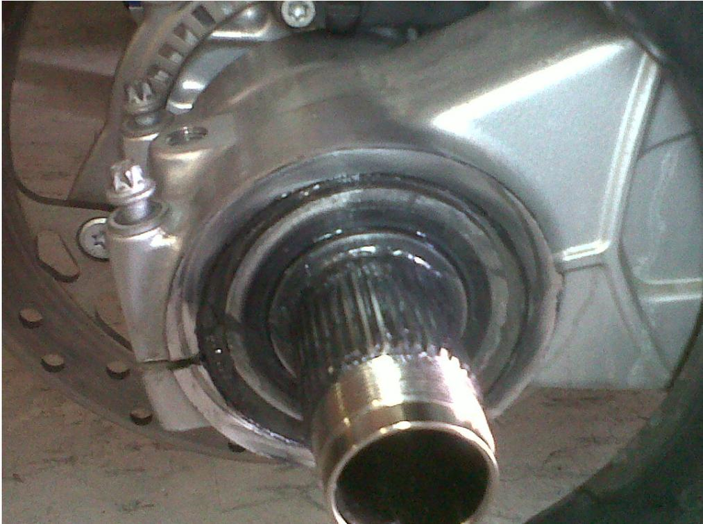
Alineando la muesca de la excéntrica con el tornillo del basculante insertamos el nuevo conjunto ayudándonos como antes con un destornillador plano poderoso para hacer palanca y facilitar las cosas. Cuando llegue a tope la fijamos con los dos tornillos laterales de sujeción de la excéntrica.
