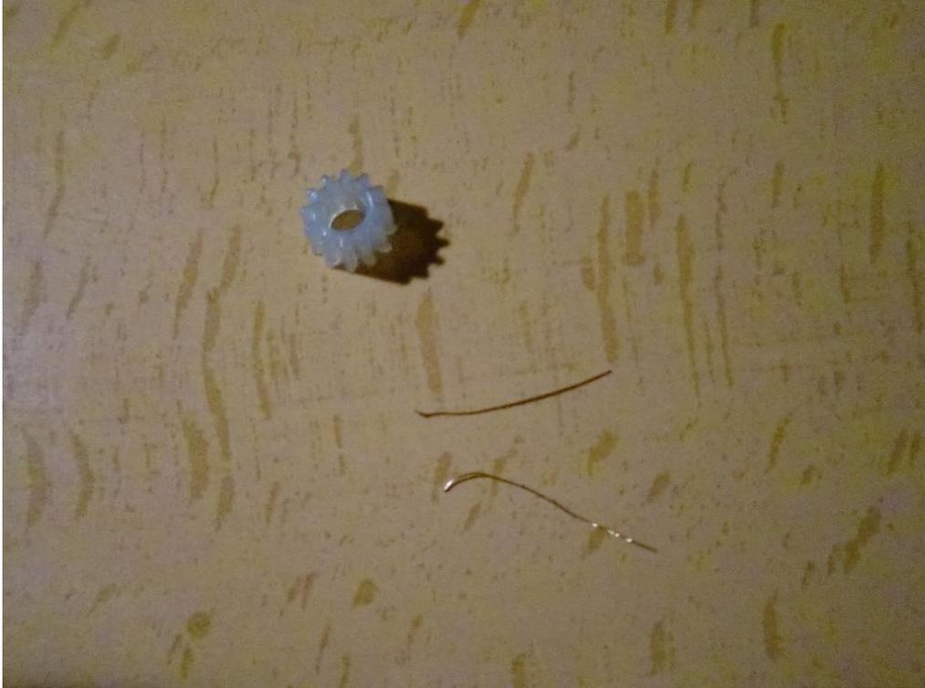
Ahora si hemos decidido cambiar el engranaje tractor tenemos que proporcionarle una chaveta que nos puede valer un pelo de cobre de cualquier conductor.
