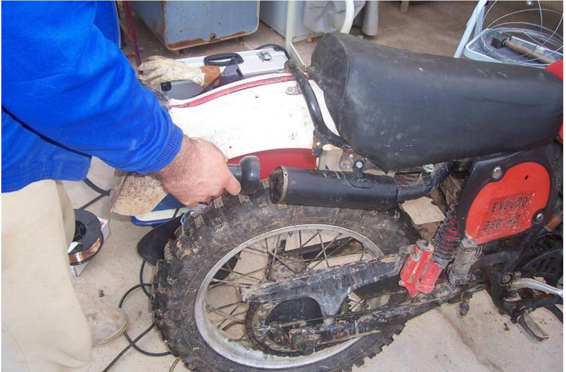
Despues de desmontar la punta del "silenciador".
