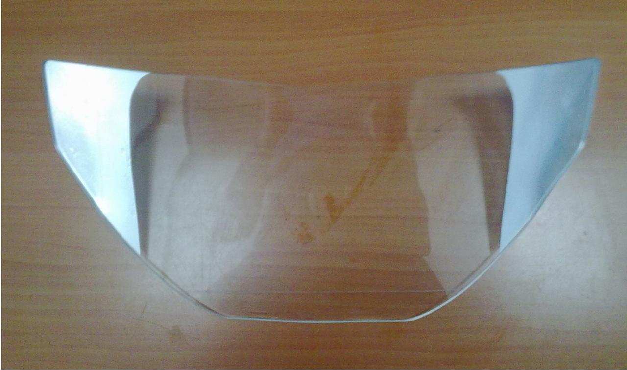
+UNA VEZ RETIRADA LA PIEZA DE LA MOTO YA SE PUEDE PULIR LOS CANTOS CON LIJA FINA DE AGUA PARA DAR TERMINACION LA LAVAMOS BIEN Y YO EN CONCRETO LE HE PUESTO POR EL INTERIOR UNAS PIEZAS DE ALUMINIO ADESIVO PARA SIMULAR FONDO DEL FARO
