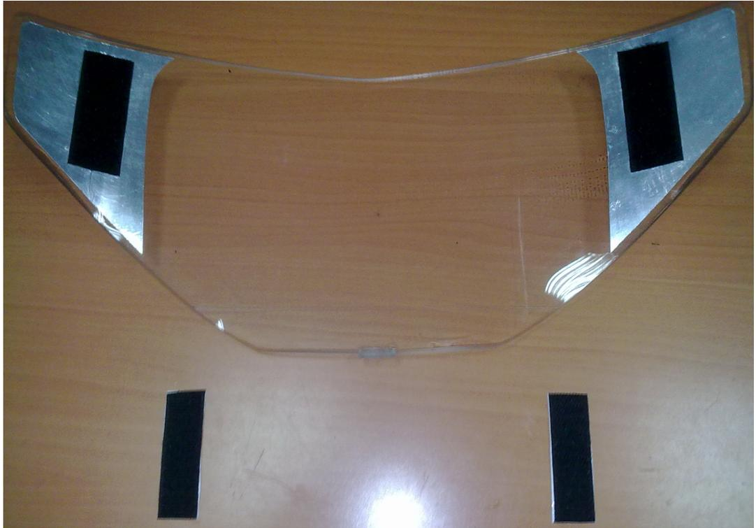
UNA VEZ CENTRADO TODO SE LE PEGA UNA PEQUEÑA PIEZA DE METACRILATO EN LA PARTE BAJA PARA QUE ENTRE EN LA RANURA QUE SE QUEDA ENTRE EL FARO Y EL CARENADO Y ASI LE SIRVA DE APOLLO Y EN LA PARTE DONDE PUSIMOS LAS LAMINAS DE ALUMINIO PEGAMOS CON PEGAMENTO INSTANTANEO DEL BUENO UNOS BELCROS Y HOS PUEDO DECIR QUE NO SE CAE PARA NADA PUES YO YA HE HECHO MAS DE 1000 KM Y NI SE COSCA Y LO MEJOR ES QUE NO TENEMOS QUE HACER NINGUN TALADRO PARA PONER TORNILLOS NI NADA Y ASI NO ESTROPEAMOS EL CARENADO.
