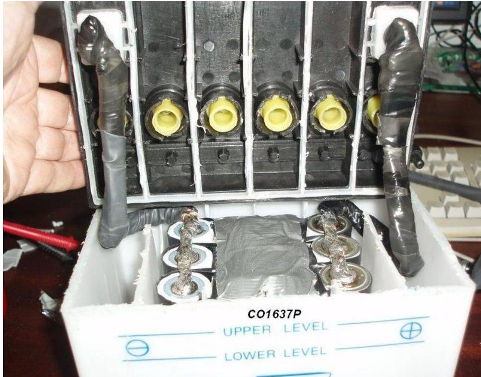
Así se ha hecho la conexión a los bornes de la tapa de la batería.
