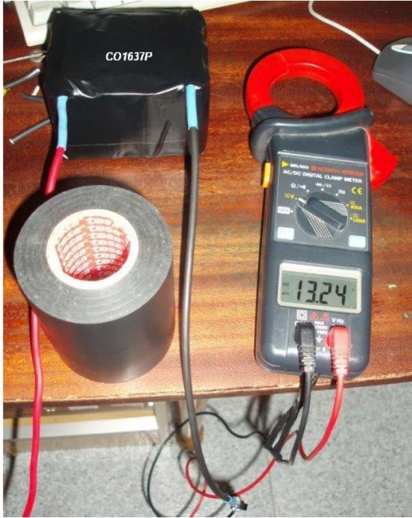
Batería conectada y comprobando tensión, fuera del alojamiento.
