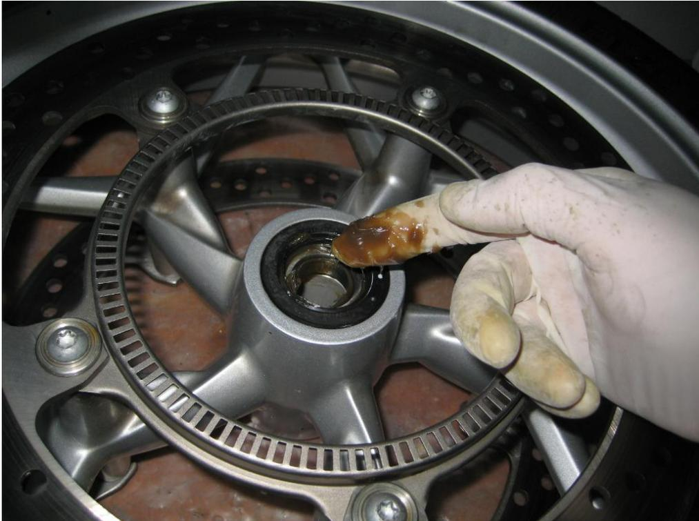
10º Engrasamos el eje, el casquillo por la parte donde roza el retén (se ve mas brillante imagen superior) y su interior, el eje de la llanta por dentro y las dos puntas de las botellas:
