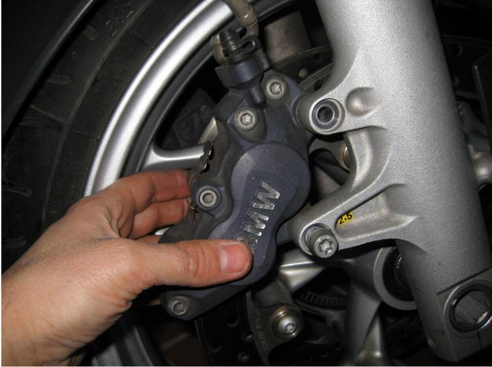
13º Montamos la pinza de frenos derecha y le damos un par de 30Nm
