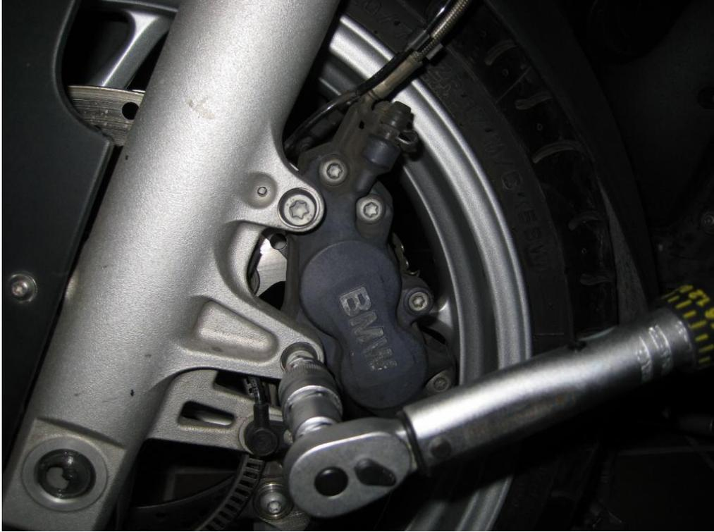
14º Montamos la pinza de frenos izquierda y le damos un par de 30Nm
