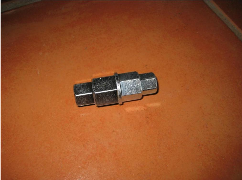
7º Desenroscamos el eje (exagonal 22mm)
